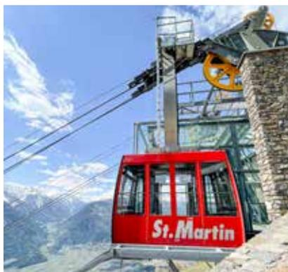
zur Kontrolle sowie für Umbau- bzw. Anpassungsarbeiten in das Werk von Doppelmayr nach Lana gebracht. Einzig die Kabine verbleibt in Latsch, sie wird zwar auch überprüft und revidiert, jedoch nicht ausgetauscht. Die jährlichen Kontrollen der Zug- und Trageile haben hervorgebracht, dass auch das obere Zugseil Abnutzungerscheinungen aufweist, sodass wir uns entschlossen haben, im selben Zuge
